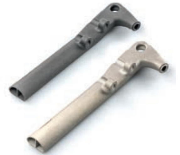
Eine von SturdyCycles entworfene Fahrradkettenstrebe. Links: PA12 Nylon. Rechts: Werkzeugstahl M2. Beide Teile wurden mit einem Sintratec Fusion Module 3D-gedruckt.
